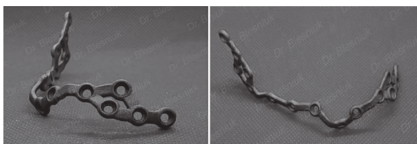
Рисунок 6 – Індивідуалізована титанова пластина для остеометалосинтезу виготовлена при допомозі 3D друку.
